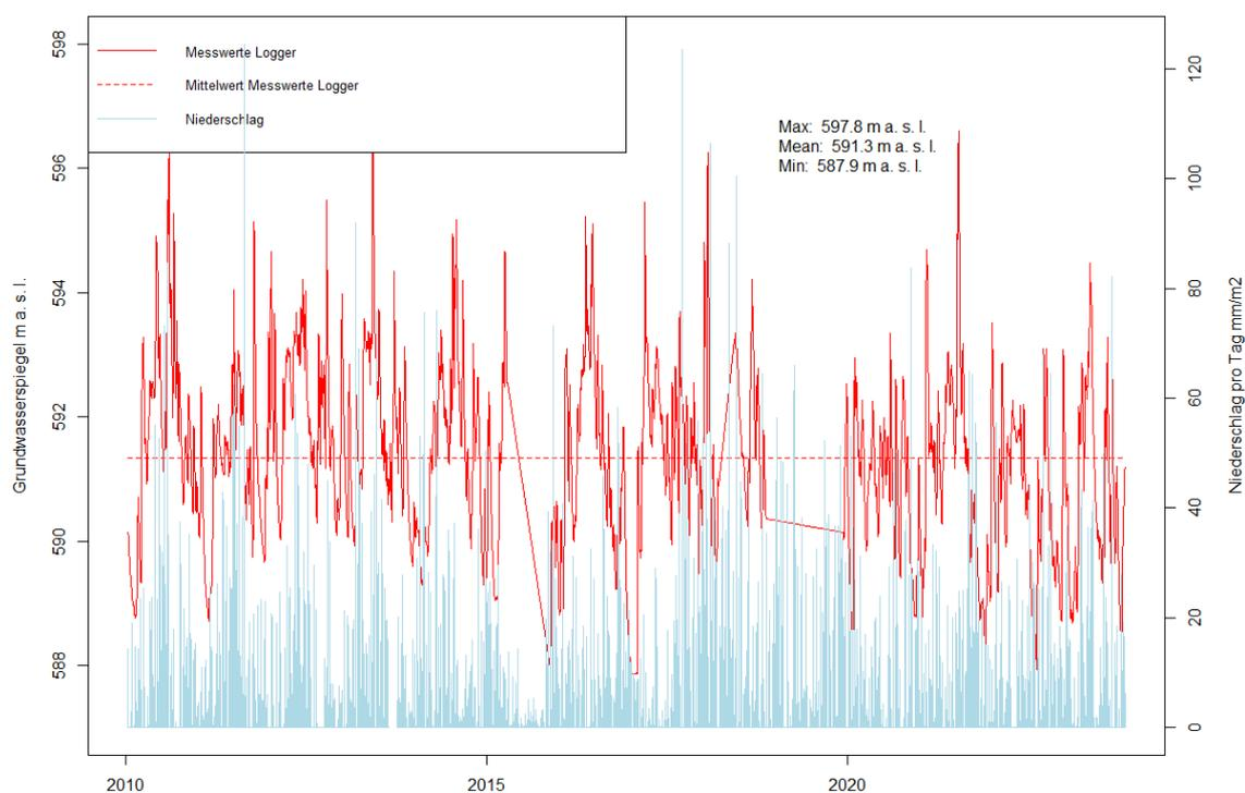
Abbildung 1 zeigt mit der **roten durchgezogenen Linie** den Verlauf des Grundwasserspiegels [m ü. M.] aus den Daten des Loggers (1 Messung pro Tag). Die **gestrichelte graue Linie** steht für den langjährigen Trend dieser Daten. Die **hellblauen Balken** zeigen den Niederschlag [mm/m²] als Wochensumme (agrometeo.ch).
